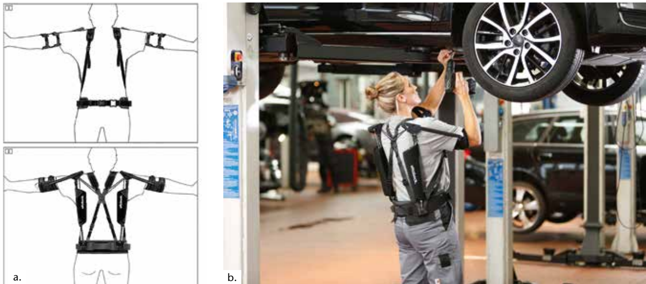
Abb. 1a u. b Das verwendete Exoskelett in der vor- und rückseitigen Ansicht (a) und bei Arbeitsabläufen in der Automobilindustrie (b).
